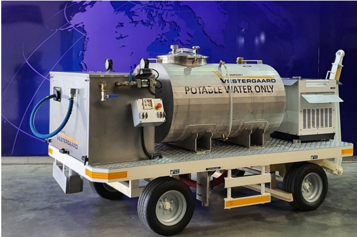
Bild 3.20 Wassertank aus EN 1.4401 (Vestergaard 2021)
