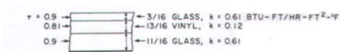
Bild 4.6 Detailzeichnung des Fensteraufbaus (nach SAE 1989)
