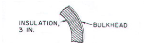
Bild 4.5 Detailzeichnung des Druckspants (nach SAE 1989 )
