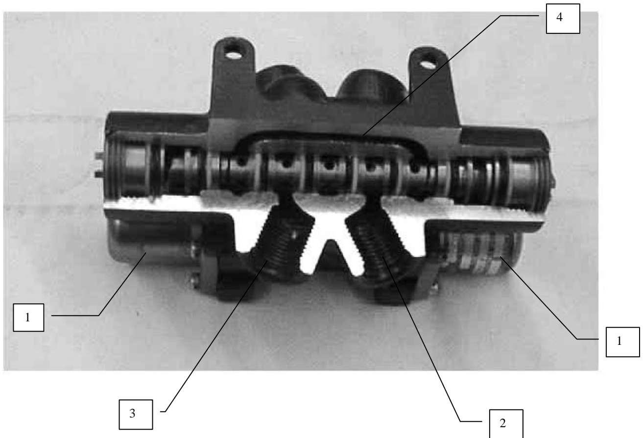
Bild 11.3: Schnittmodell eines 4-3 Wegeventils
