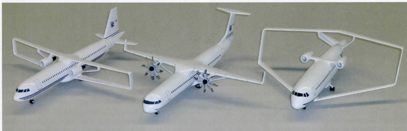
Studien zu innovativen Flugzeugentwürfen: Boxwing Flugzeug mit Flügelstrebe, großes innovatives Propellerflugzeug, Diamond Boxwing Flugzeug
