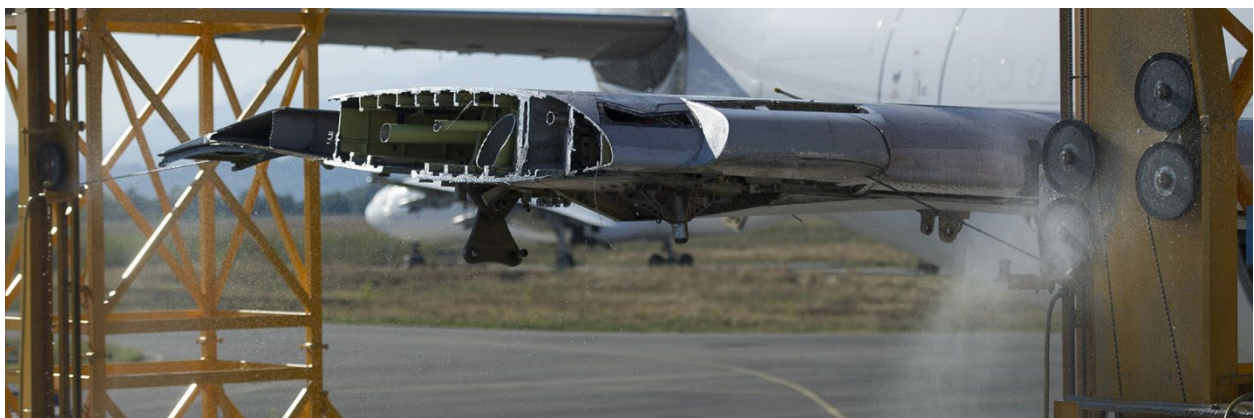
Zerschneiden eines Flügels bei Tarmac Aerosave. Quelle: https://www.tarmac aerosave.aero .
