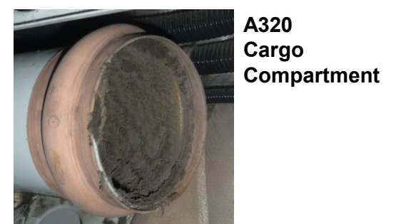
Ablagerungen der Kontamination in Teilen der Klima- und Zapfluftanlage an Bord.
