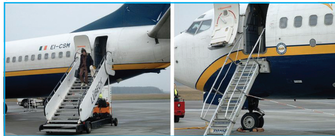
Bild 7: Bordtreppe und Lufttreppe
